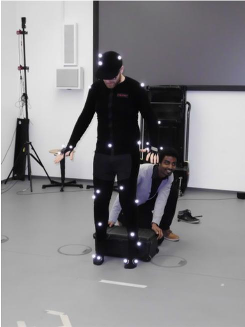
Die Aufnahme kann man in ARENA einfach mit einem Klick starten und ebenso einfach die Aufnahme beenden. Während der Aufnahme bekommt man farblich in Orange oder Rot angezeigt, falls etwas mit der Marker-Erkennung nicht klappt, wobei man dann häufiger in die T-Pose zurück muss.
