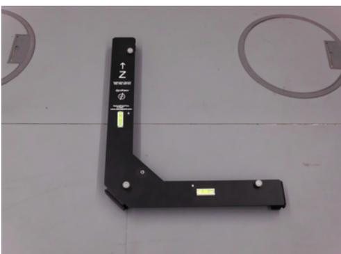
Mit dem Bodendreieck soll die virtuelle Boden-Ebene (Ground Plane), auf der das Skelett-Modell stehen soll, kalibriert werden. Das Bodendreieck ist ebenfalls mit Markern versehen die von den Infrarot-Kameras erfasst werden. Diese gedachte Boden-Ebene wird von der X- und der Y-Achse aufgespannt. Der Boden entspricht dem minimalst möglichen Z-Wert des Modelles mit einem Wert von 0. Damit wird verhindert, dass das 3D-Modell mit den Füßen im Boden versinkt.
