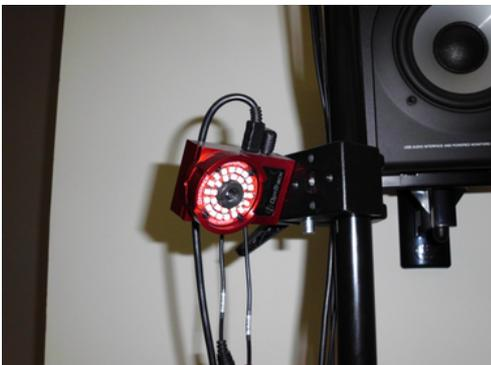
Bei den Kameras im MoCap-Studio handelt es sich um 12 Kameras des Modells V100:R1, die jeweils mit 100 Bildern die Sekunde bei einer Bildauflösung von 640 x 480 Pixeln Infrarotlicht (kurz: IR) aufnehmen.
