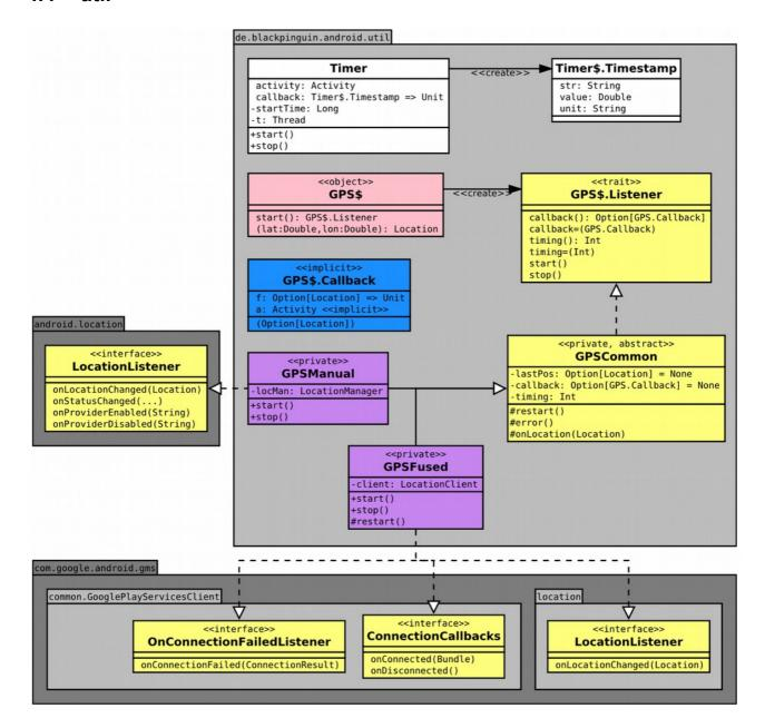
Die Klasse Timer realisiert über einen zusätzlichen eigenen Thread die Funktionalität einer Stoppuhr, die kontinuierlich während sie läuft über die callback-Funktion ihren aktuellen Anzeigewert der Activity mitteilt. Eine Referenz auf die Activity wird dabei benötigt, um die callback-Methode nicht innerhalb des eigenen Threads auszuführen, sondern im Kontext der Activity, weil andere Threads nicht über die ausreichenden Berechtigungen verfügen, um die Widgets der Activity verändern zu dürfen.
