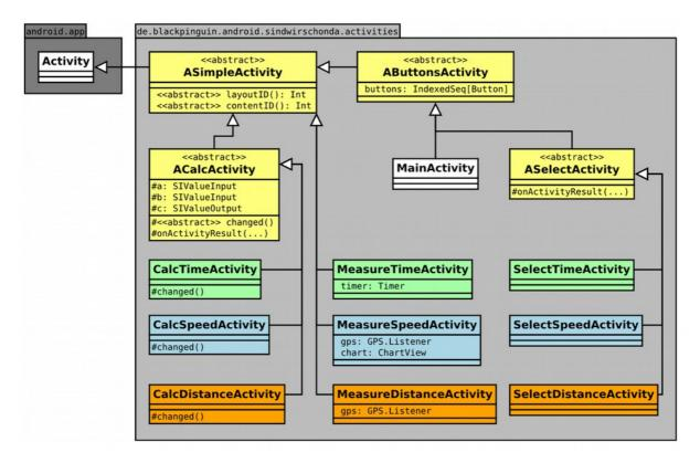
Alle Activities in diesem Paket leiten sich von der abstrakten Oberklasse ASimpleActivity ab, welche den Unterklassen u.a. die Arbeit abnimmt, das Layout in der onCreate-Methode zu setzen, wozu diese wiederum lediglich einzeilig die Methode getLayoutID implementieren müssen (z.B.: def getLayoutID = R.layout.activity\_calc\_distance).
